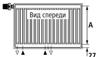
**Указание:** при подключении по центру подающий трубопровод всегда расположен слева, вне зависимости от расположения вентиля.
