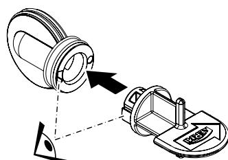
2. Проверить правильность положения разделительной пробки с помощью монтажного ключа:
