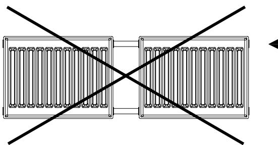
**Указание!** Требуется комплект разделительных пробок ZT00810001. Соединение стальных панельных радиаторов монтажной высотой 200/205 мм без разделительных пробок.
