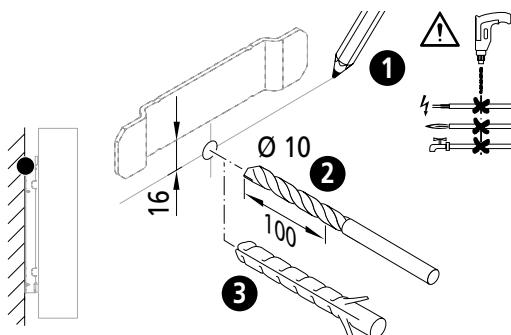
**Внимание!** Крепежный материал предназначен для монтажа в основания с достаточной несущей способностью. Тем не менее, необходимо проверить крепеж и способ крепления на месте установки и подобрать его, в случае необходимости, с учетом конкретной монтажной ситуации!
