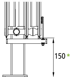
\* Указание: размер для установки на готовом полу
