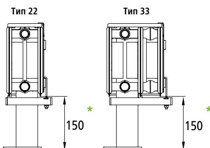
\* Указание: размер для установки на готовом полу
