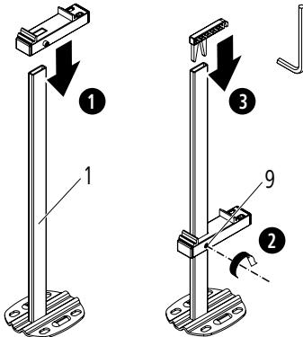
Предварительная сборка вертикальной консоли монтажная длина  $\geq 1800$  мм
