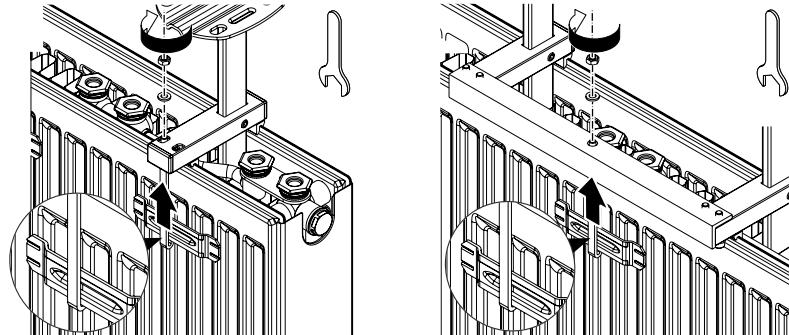
5. Выполнить разметку отверстий, просверлить отверстия и вставить дюбели
