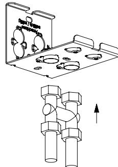
**Внимание!** Соединение «соединительная пробка (B) и резьбовое подключение» не является герметичным.
