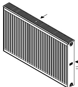
Боковую планку слегка наклонить и потянуть от радиатора (см.рисунок), после приподнять верхнюю планку и снять боковую планку с фиксирующего крючка.
