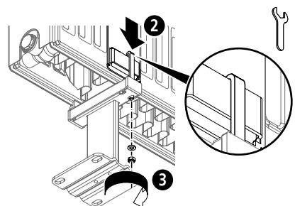
6. Выровнять радиатор по горизонтали, затянуть установочные винты для горизонтальной фиксации (10 Нм)
