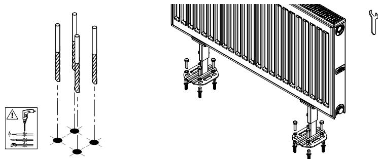
6. Выровнить радиатор по горизонтали и затянуть фиксирующие винты
