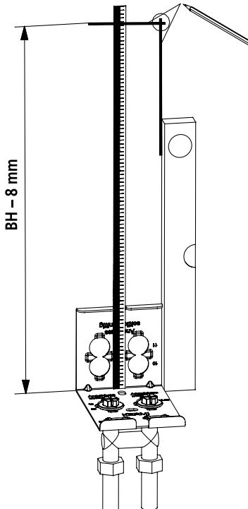
13. Сверление отверстий для креплений и монтаж использованного настенного крепления согласно прилагаемому руководству по монтажу.
