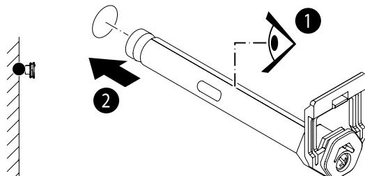
**Указание:** при наличии на стене защитно-изоляционного слоя максимальный отступ от стены сокращается на толщину защитно-декоративного слоя и/или изоляционного материала (см. рис. внизу). Область разводки кронштейна не должна находиться полностью в полости строительного материала
