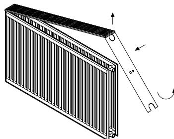
Затем поднять с одной стороны и сдвинуть верхнюю планку, чтобы отсоединить ее от второй боковой планки.
