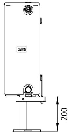
\* Указание: размер для установки на готовом полу
