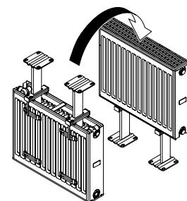
5. Выполнить разметку отверстий, просверлить отверстия
