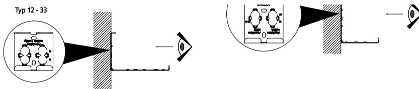
**Внимание!** Тип 10: расстояние от стены 50 мм / тип 11-33: расстояние от стены 30 мм
