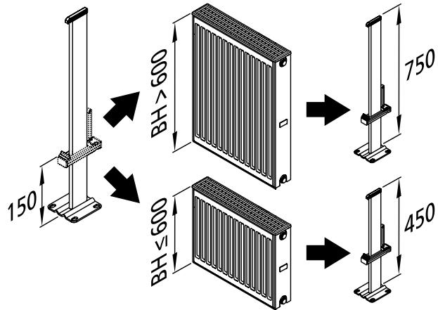
**Указание:** класс требований 2 действителен только при монтажной высоте до (BH): 300 - 954 мм
