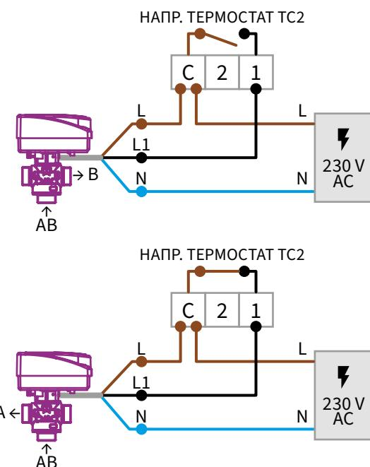
Управление 3-ходовым клапаном AZV с помощью терmostата TC2
