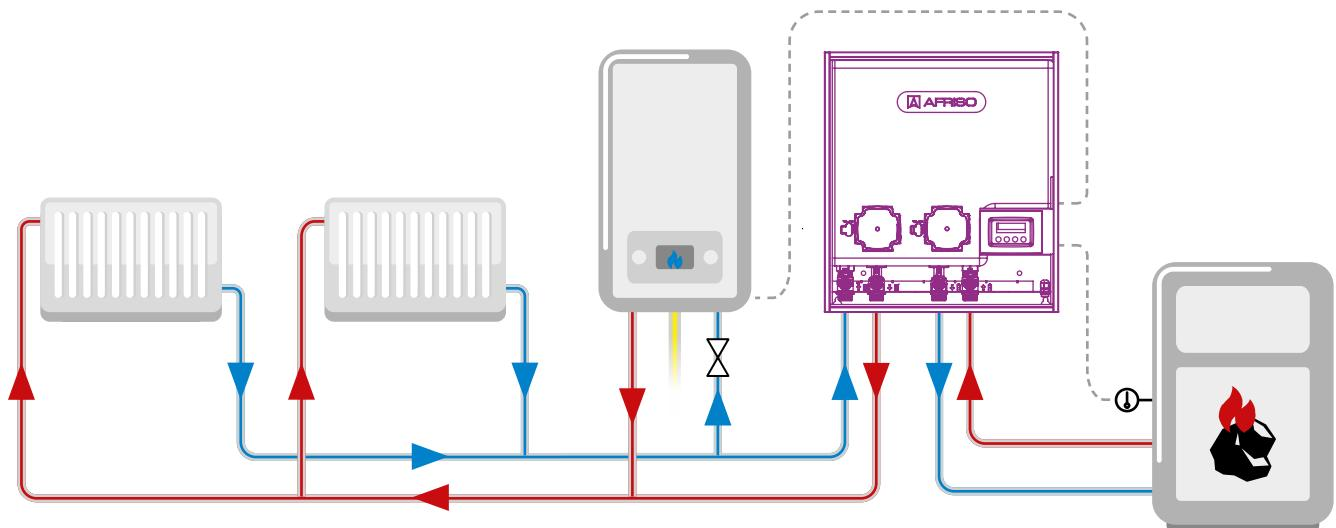
Схема использования разделительного набора PrimоБокс AHB 622
