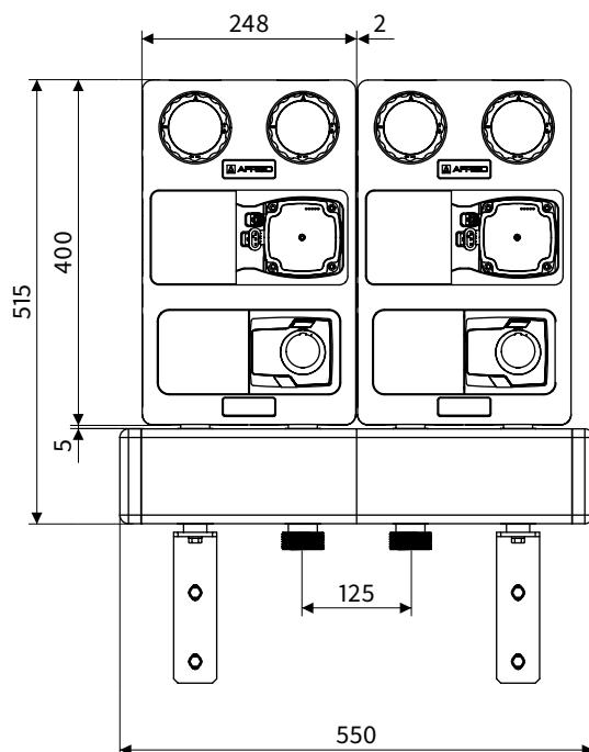
**PrimoTherm, PrimoTherm K, KSV 125-2 и гидравлическая стрелка HW**
