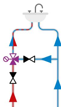
Клапан ATM поддерживает постоянную (установленную) температуру для выбранной точки водоразбора
