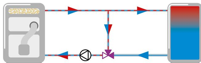
**Этап 2.** Когда котел достигнет необходимой температуры, термический клапан ATV открывает большой контур через бак аккумулятора и начинает процесс загрузки, поддерживая необходимую температуру в обратном трубопроводе.
