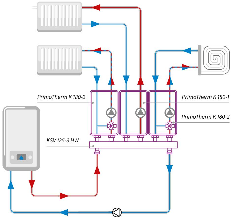
Схема использования трех насосных групп PrimoTherm: прямой и двух с подмесом, установленных на коллекторе KSV.
