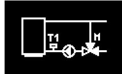
Схема со смесительным клапаном, установленным на обратной линии источника тепла для защиты котла от низкотемпературной коррозии
