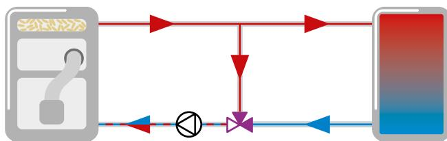
**Этап 3.** Во время процесса загрузки бака, термический клапан ATV регулирует поток через два контура, чтобы поддерживать необходимую температуру (малый) в обратном трубопроводе и нагревать бак аккумулятор (большой).
