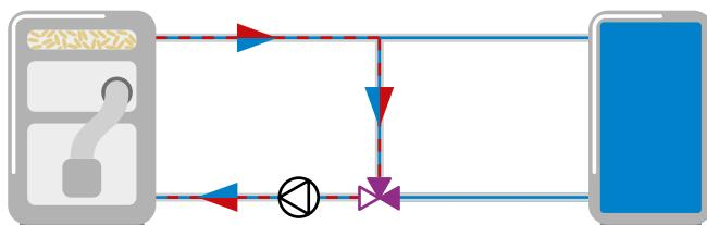
**Этап 1.** После запуска котла термический клапан ATV открывает только малый контур. Благодаря этому, источник тепла нагревается до тех пор, пока не достигнет необходимой температуры (температуры настройки клапана).
