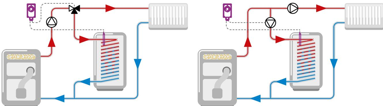
Управление работой переключающего клапана с помощью термостата ТС2.
