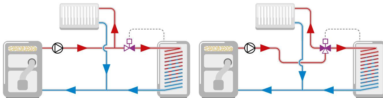
2-ходовой клапан AZV позволяет реализовать приоритет при нагреве водонагревателя, используя погружной термостат AFRISO (смр. 93)
