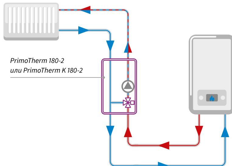
Схема использования отдельной группы PrimoTherm 180-2 для радиаторного отопления.
