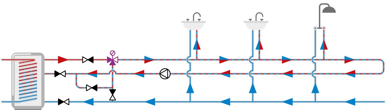
Клапан ATM поддерживает постоянную (установленную) температуру в системе ГВС при наличии циркуляционного насоса. Обязательно использовать расширительный бак на подающей линии ГВС после клапана ATM
