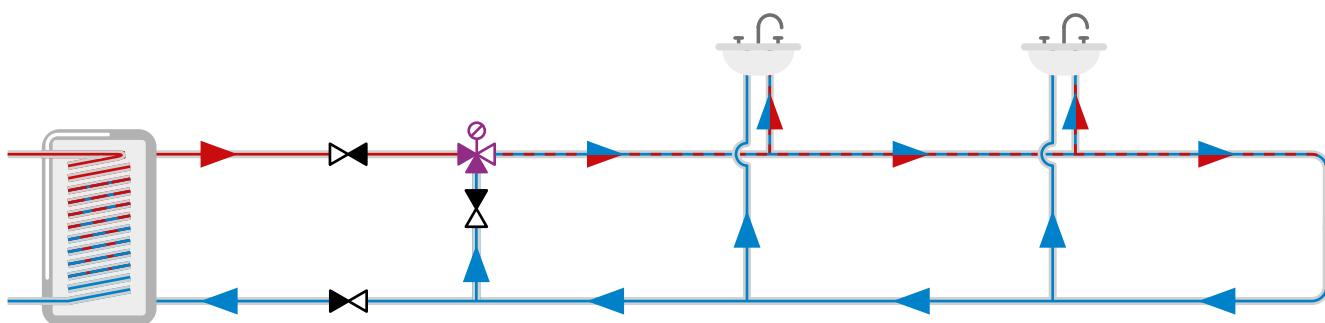
Клапан ATM поддерживает постоянную (установленную) температуру в системе ГВС
