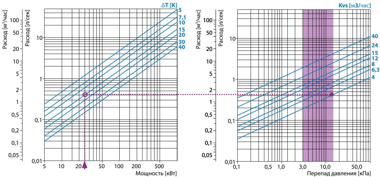
1. Определите тепловую мощность системы или котла в кВт, для которых устанавливается клапан.
