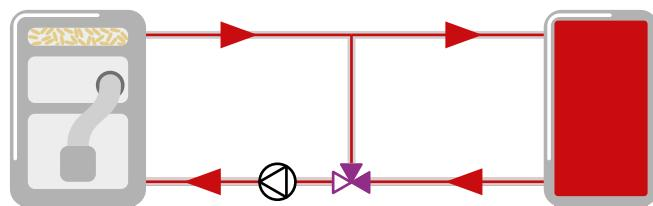
**Этап 4.** Когда бак аккумулятор нагрет, термический клапан ATV закрывает малый контур и полный поток идет через змеевик бака, без подмеса. Полное закрытие малого контура произойдет при достижении температуры обратной линии на 10°C больше, чем настройка температуры клапана ATV.
