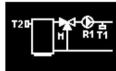
Схема со смесительным клапаном, установленным на подаче для поддержания заданной температуры
