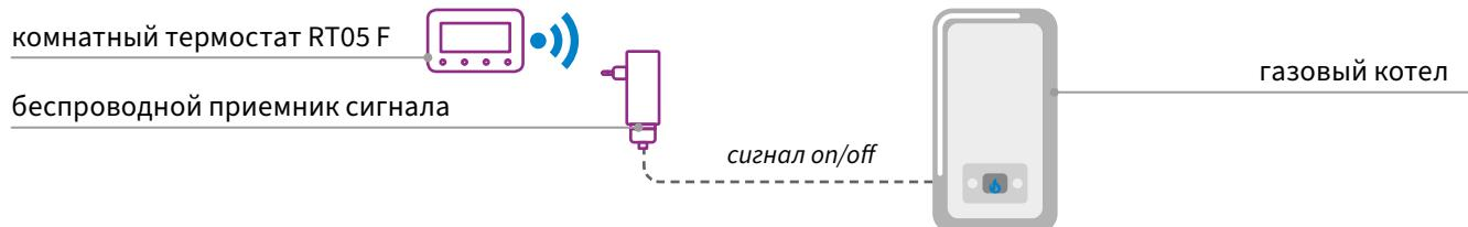
Схема использования: контроллер RT05 F для управления газовым котлом
