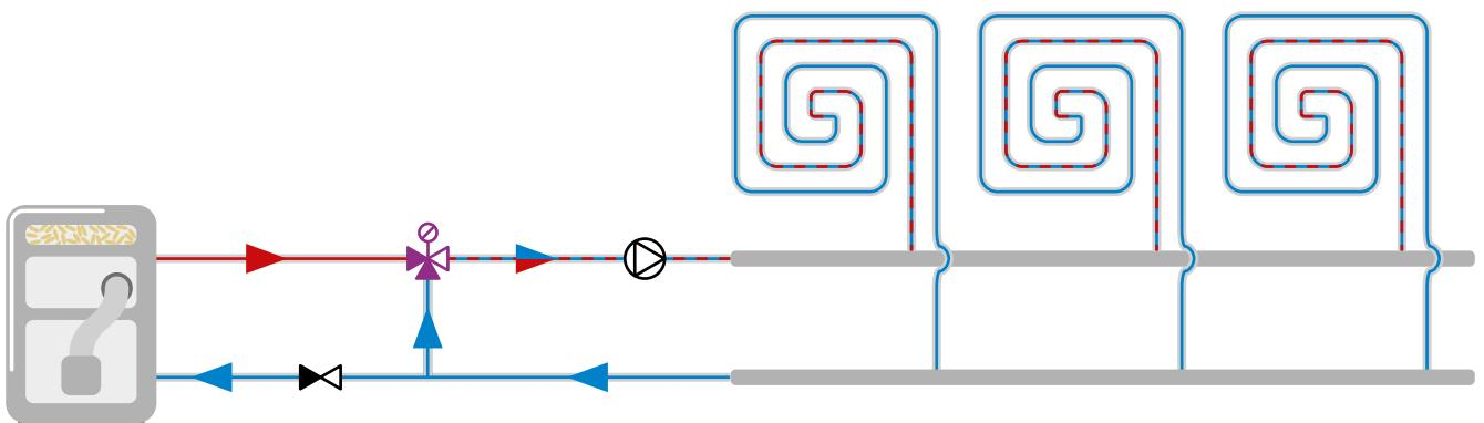
Терmostатический смесительный клапан ATM поддерживает постоянную (установленную) температуру в системе теплого пола. Может быть установлен непосредственно перед коллектором. Клапаны с температурным диапазоном 20÷43°C оптимально подходят для данных систем.
