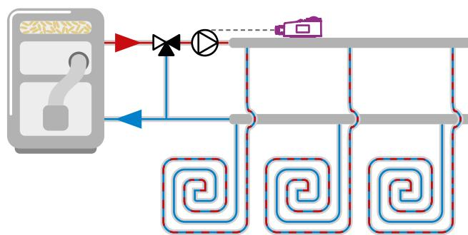
Накладные термостаты BRC необходимо использовать в системах из труб, восприимчивых к высокой температуре (например: системы теплого пола, отопительные системы из полимерных труб и т.п.).
