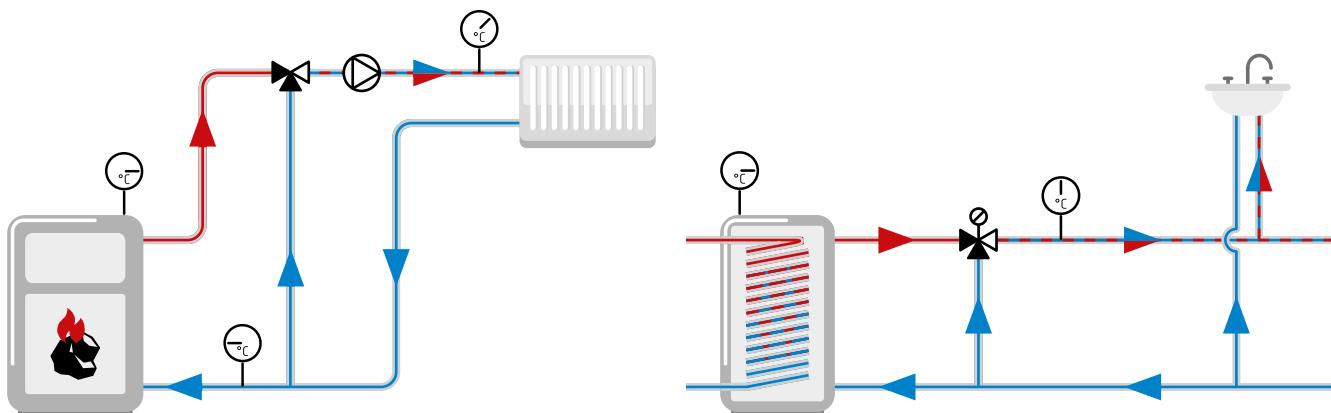
**Установка термометра на обратной и подающей линиях источника тепла, позволяет определить разницу температуры между подающей и обратной линий. Значение теплосъема теплоносителя сигнализирует о правильной работе системы.**
