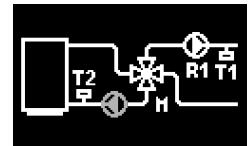
Схема с 4-ходовым смесительным клапаном для защиты котла от низкотемпературной коррозии
