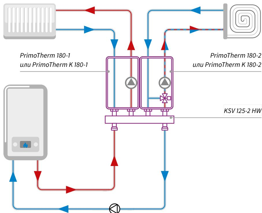
Схема использования двух насосных групп PrimoTherm, прямой и с подмесом, установленных на коллекторе KSV.
