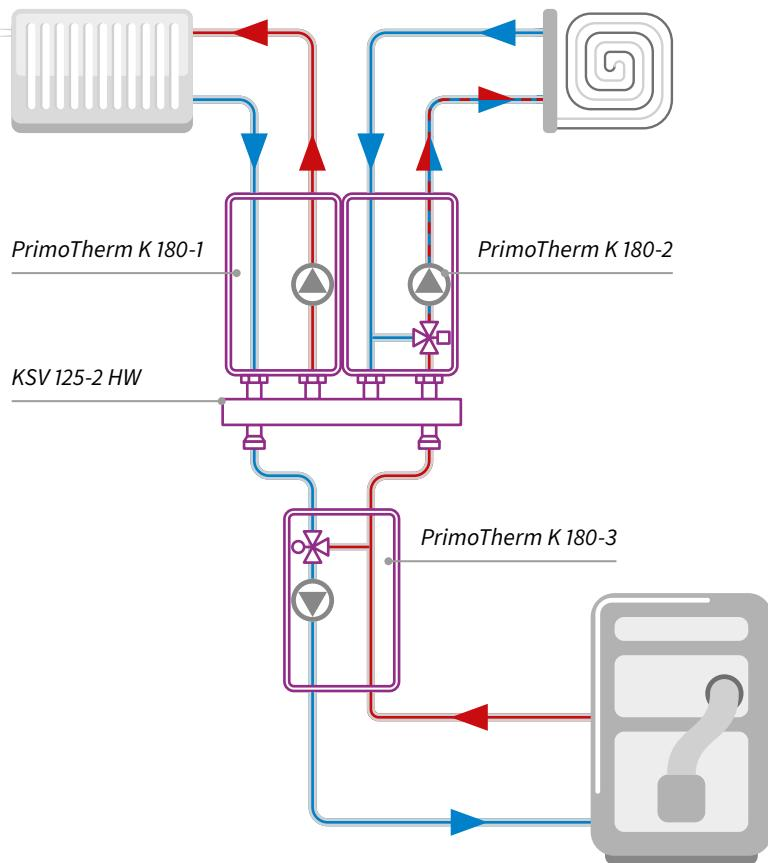
Схема использования двух насосных групп PrimoTherm: прямой и с подмесом, установленных на коллекторе KSV. Дополнительно насосная группа PrimoTherm 180-3 установлена для защиты котла от низкой температуры обратной линии.
